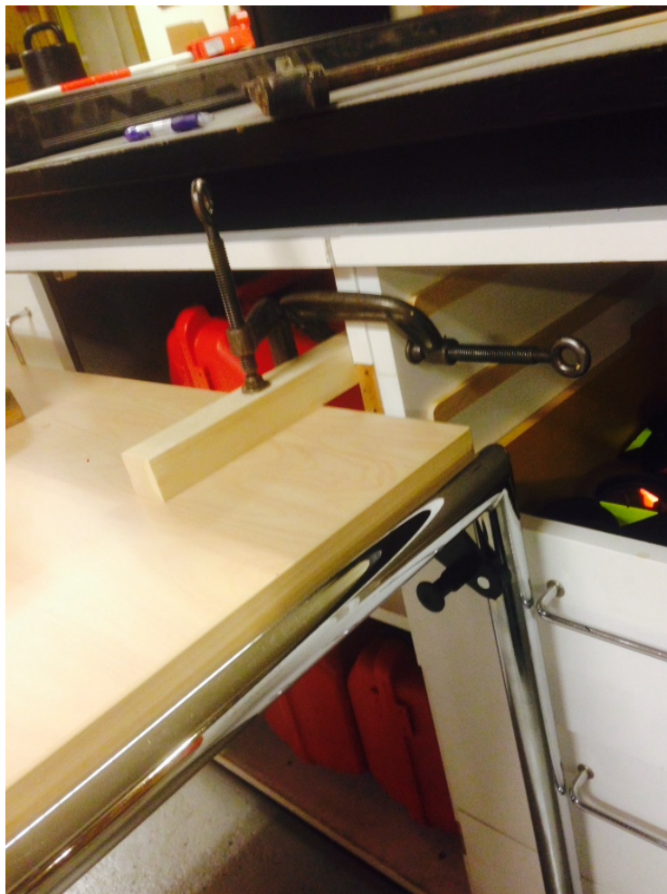
Figur A.3: Foto af skruetvinge anvendt til fastmontere forsøgsbord med kommode.
