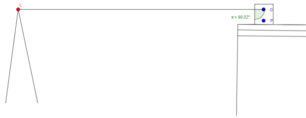
Figur 5.4: Illustration af forsøgsbord i forhold til Lasertracker set fra siden. P er punktet der skal måles, hvor punktet O er reflektoren i B-Proben
