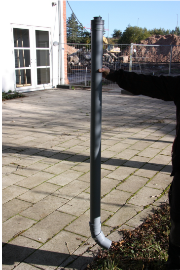
Figur 2.3. Rør med bøjning klar til montering ved målestation ØST3.
