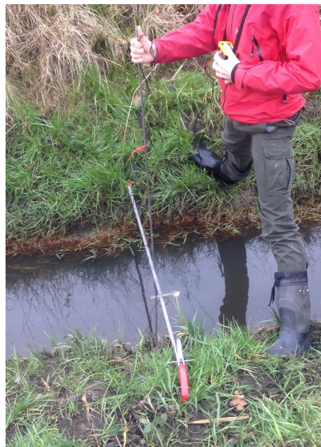
Figur 2.10. Propelmåling i Vester Landgrøft udført tæt på målestation VL1.
