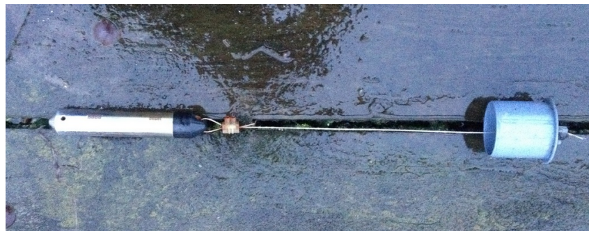
Figur 2.6. Tryktransducer monteret i et ventileret låg.
