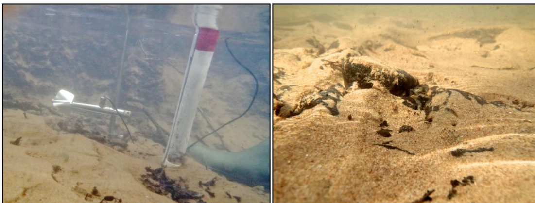
Figur 4.7 Til venstre: Propel til måling af vandhastighed samt landmålerstok med tommestok til højdemåling. Til højre: Substrat vurderes som sand på trods af, at der tydeligt ligger grus neden under (egne billeder).
