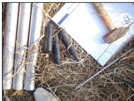
Figur 4.10 Tre tryksensorer til måling af vandstuvning samt tilhørende jernrør til installation (eget billede).
