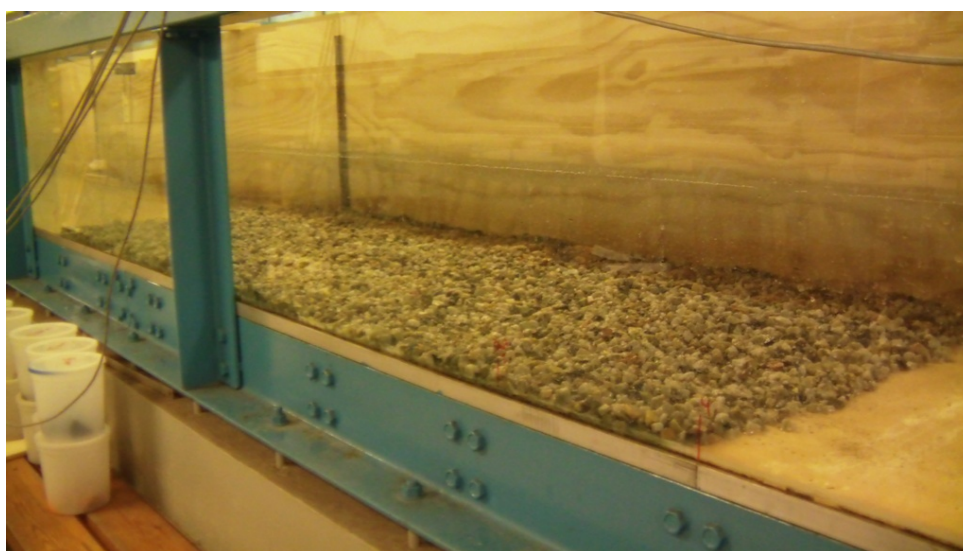
Figur E.2. Slutningen af sediment laget set fra siden, inden skyllebølgen aktiveres.
