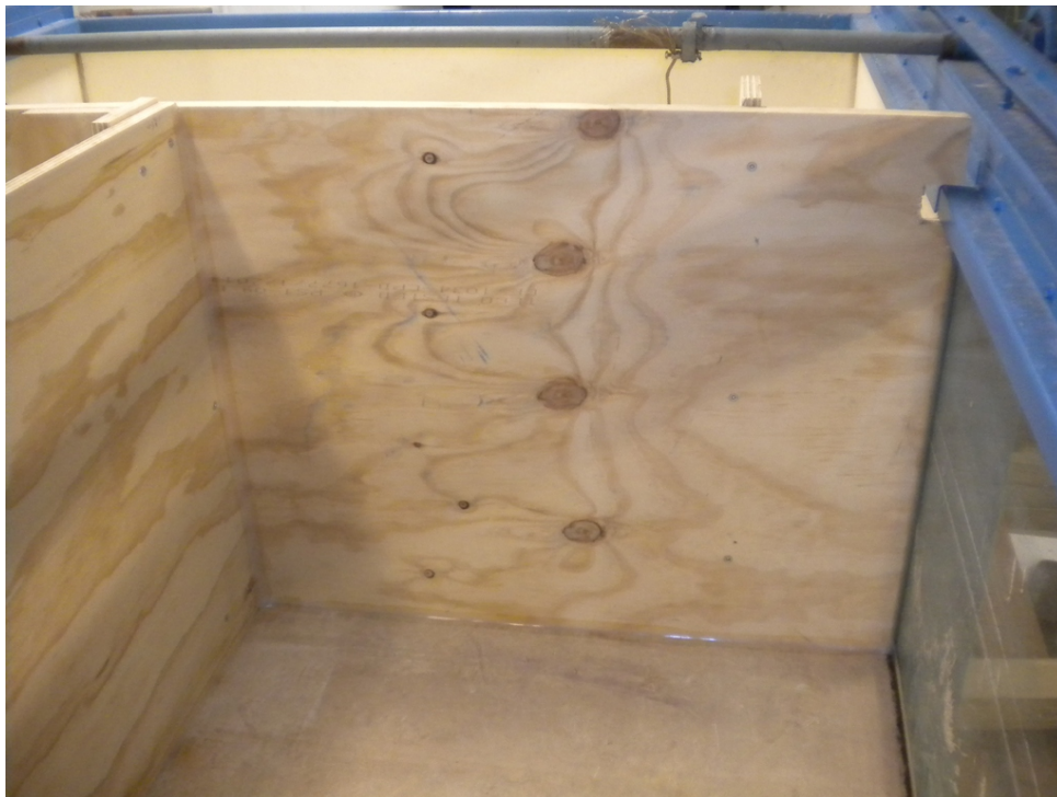
Figur 5.10. Forseglingen af strømningsranden nær udløbet.
