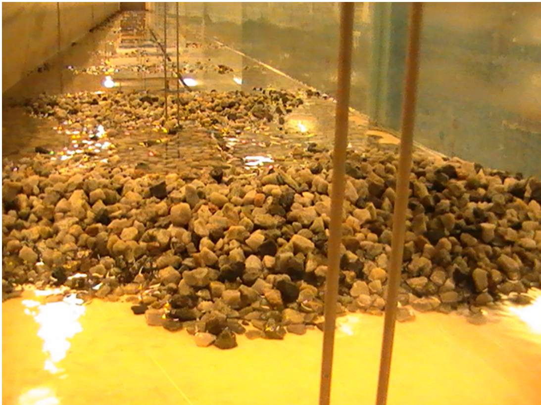
Figur E.4. Sediment lagets fordeling efter få skyllebølger.
