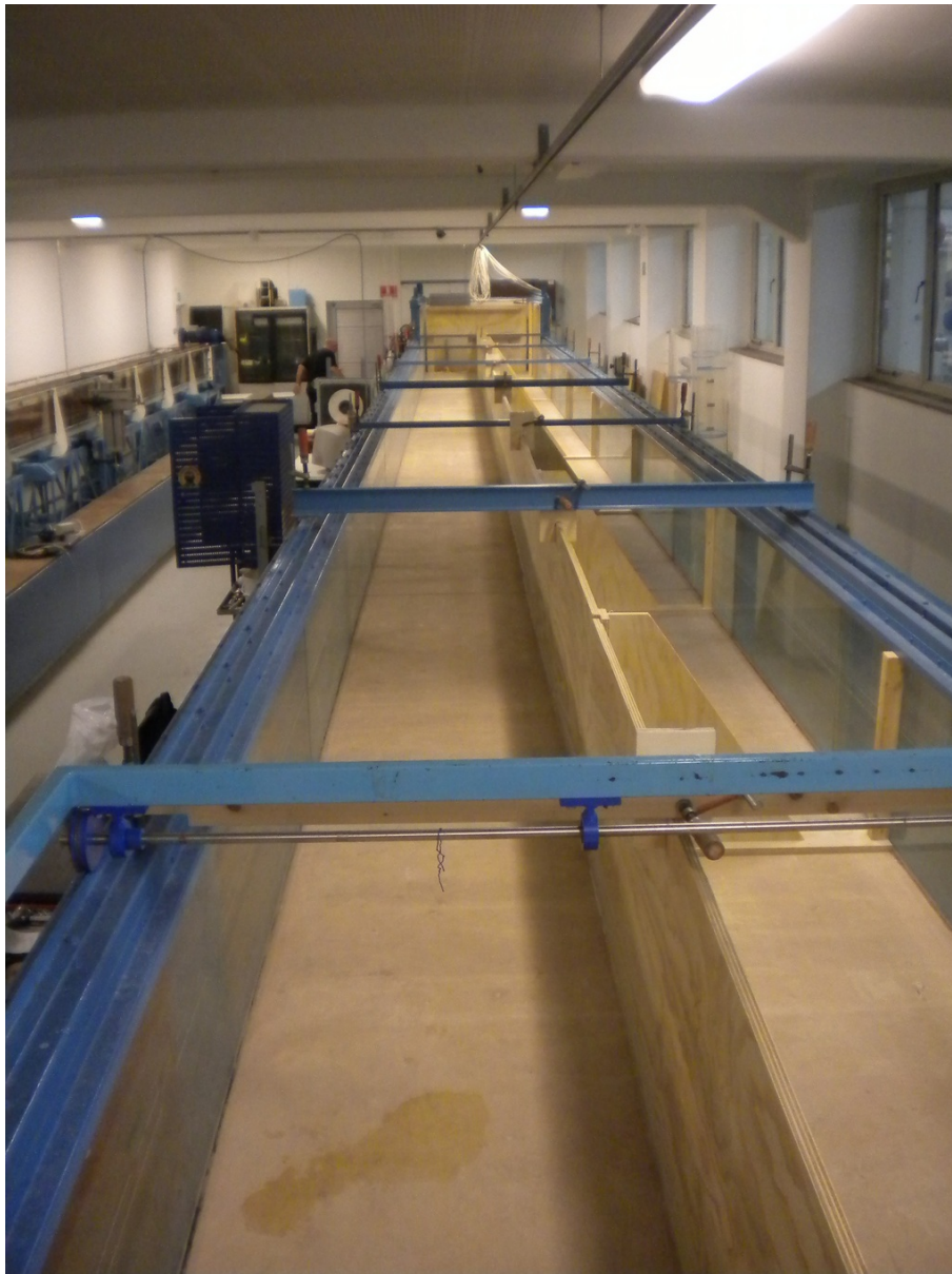
Figur 5.3. Strømningsranden med indsnævret bredde.
