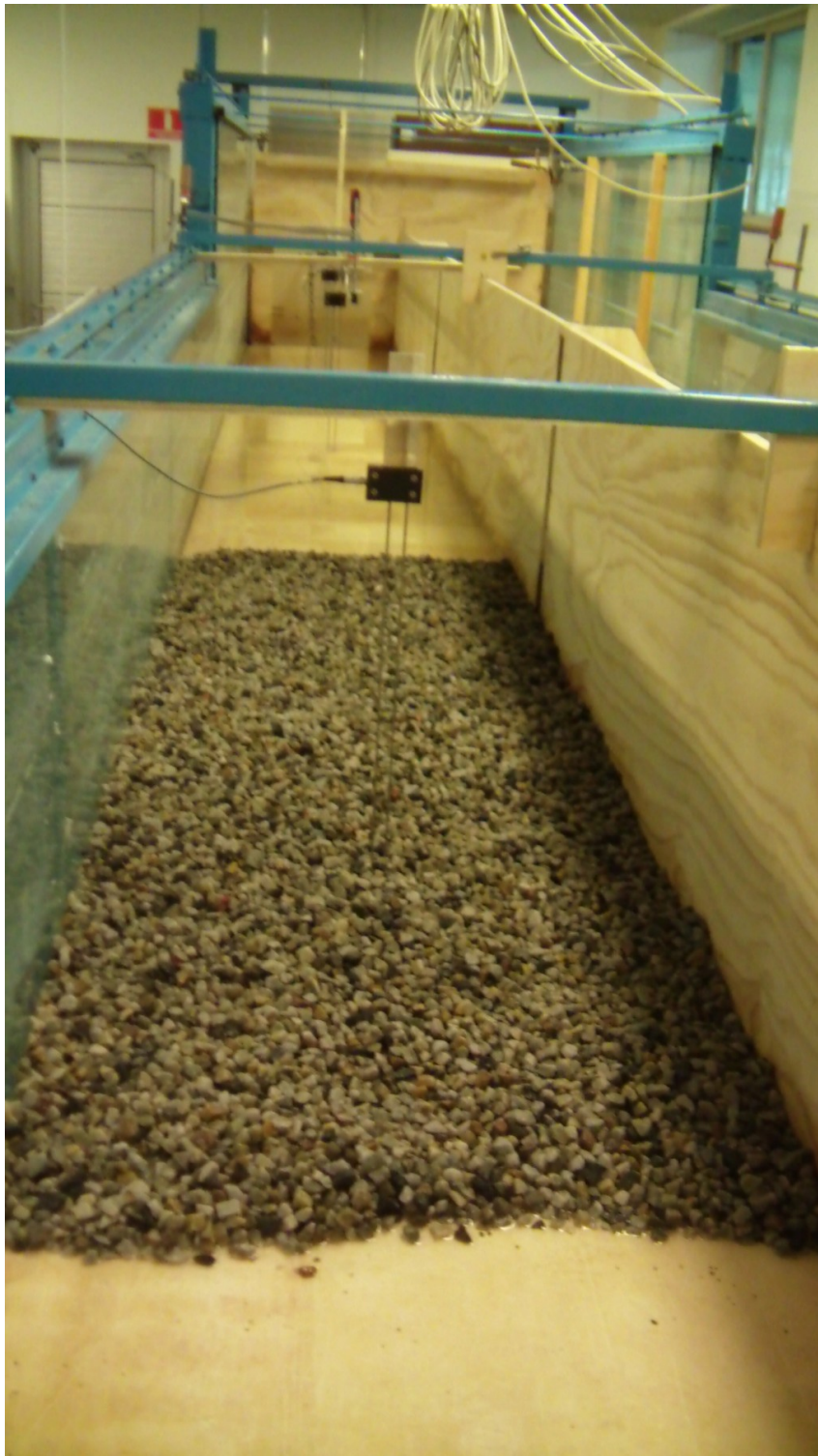
Figur E.3. Udlagt sediment lag tæt på indløbet, ud fra målerens placering, findes starten af laget til 5,4 m fra indløb
