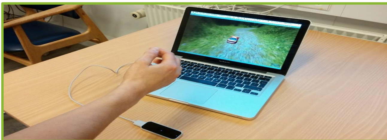
Figur 4.5. Billedet viser hvordan hånden holdes over Leap Motion og styrer bevægelsen i spillet
