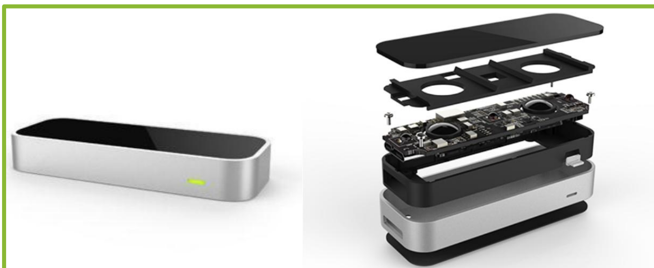
Figur 4.3: Billedet viser hvordan Leap Motion ser ud og hvor mange lag den består af.(43)
