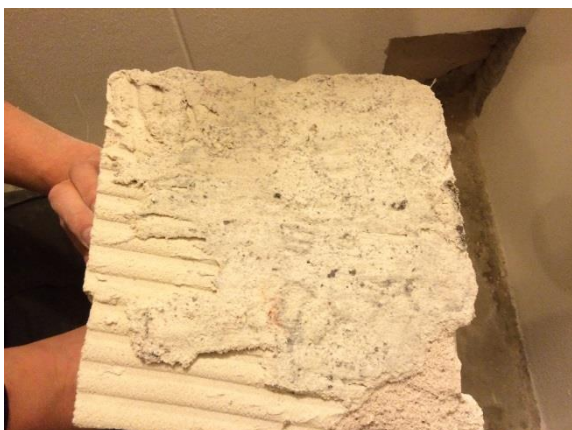
Billede 14 Udtaget Ytong plade fra åbning Y2, hvor plade kom fri i et stykke inkl. det meste af klæber
