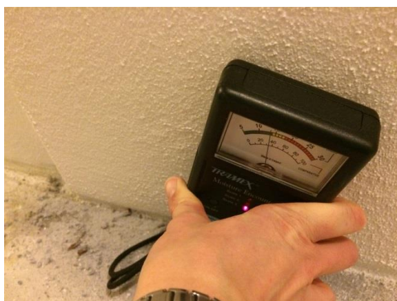
Billede 8 Svage udslag på fugtmåler Tramex med måleværdier på RV 35
