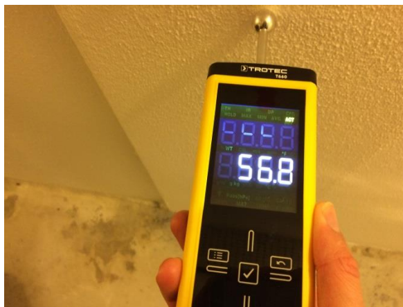
Billede 3 Overfladefugtmåling foretaget med kapacitetsfugtmåler af mærket Trotec T660. Viser tør overflade
