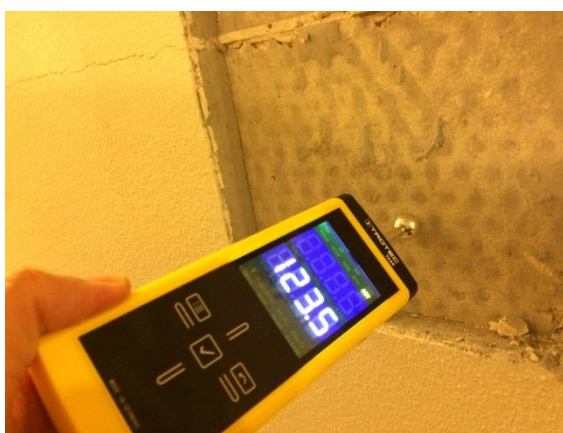
Billede 7 Tydelig opfugtning i klæbelag bag Skamol plade i åbning S2
