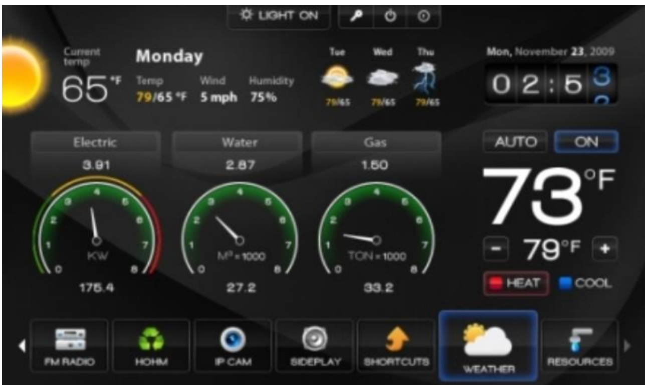
Figur 61 Amerikanske Silver Pack, som sælger termostater har lanceret et HEM system med Zbee modtagelse - prisen er ukendt. og der mangler et nøgletal i deres visning, til at vise normal forbruget.
