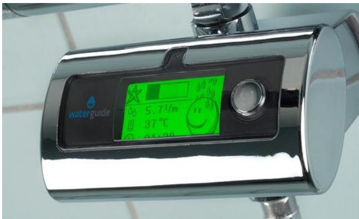
Figur 53 Waterguide der viser forbrug af varmt vand og energi medens du bader og med smileys og lyde – en opfindelse af danske Thorkild Rasmussen.
