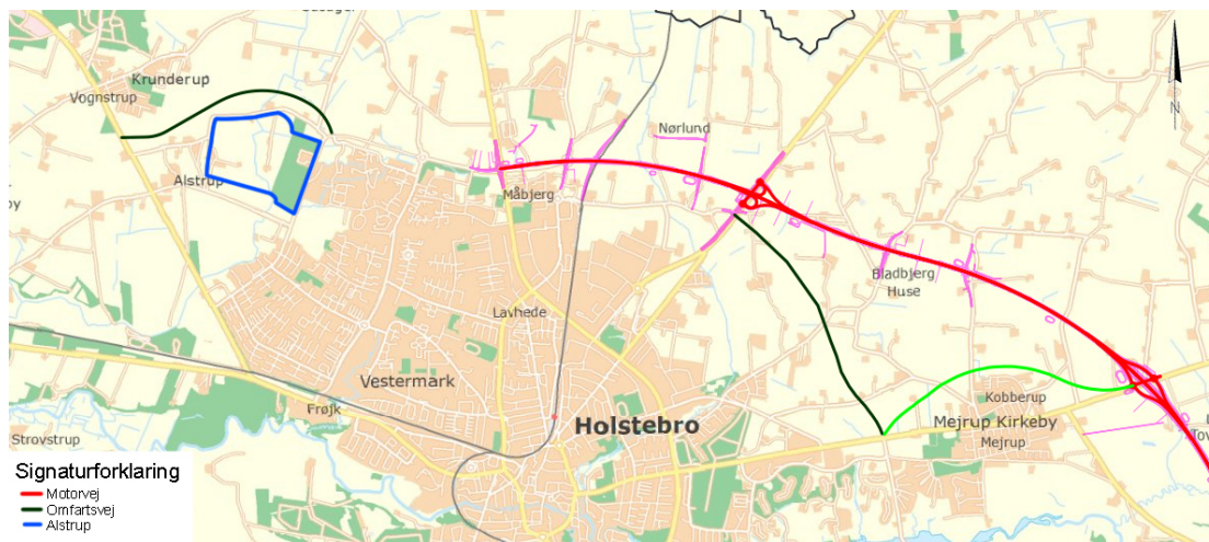
Figur 1.1: Linjeføring for den nye motorvej samt fremtidig udbygning af Nordre Ringvej mod vest. [Holstebro Kommune, 2013c]
