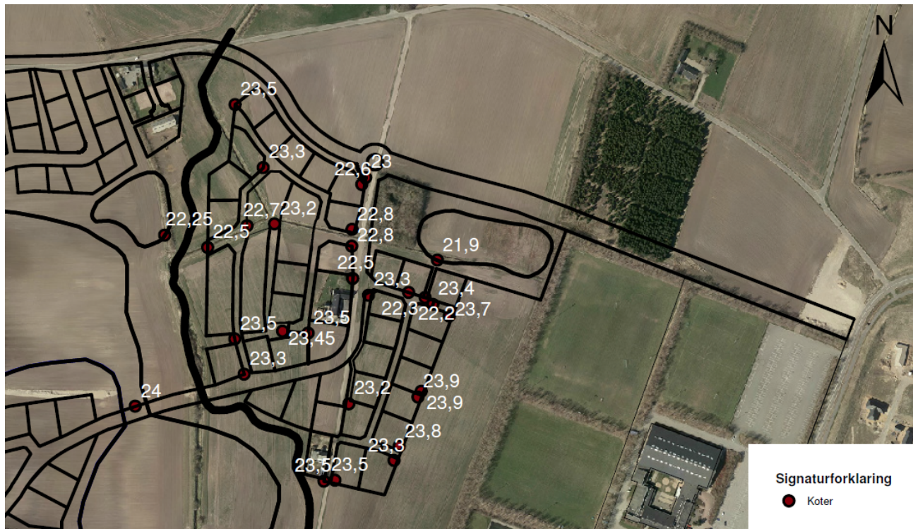
Figur 5.2: Start og slutkoter på grøfter og kanaler
