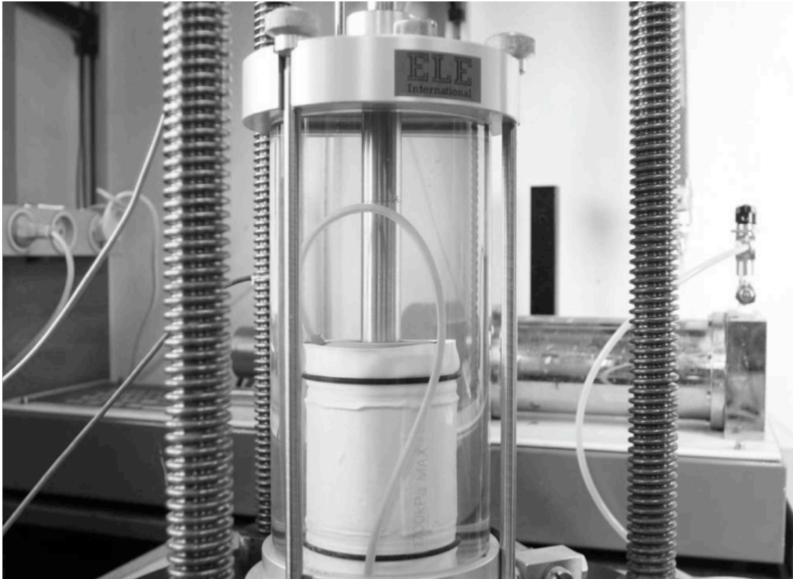
Illustration 11 viser en forsøgsopstilling, som dem Geo bruger til at producere brudkurver.
