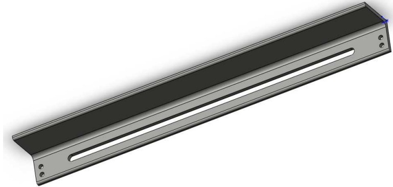
Figur 44 viser det universale trafo beslag. Denne er designet ud fra en standard vinkelprofil.
