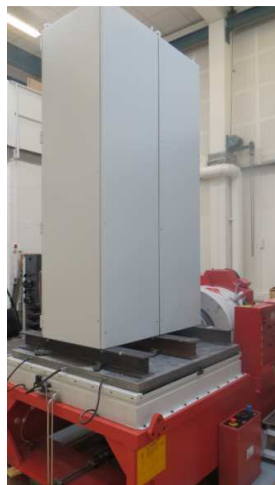
Figur 16 viser test opstilling til vibration og chok test.
