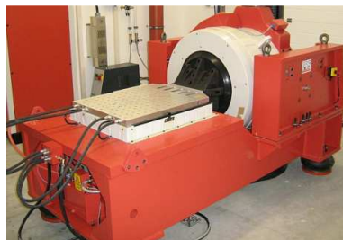
Figur 15 viser Shaker til anvendelse ved vibration og choktest.
