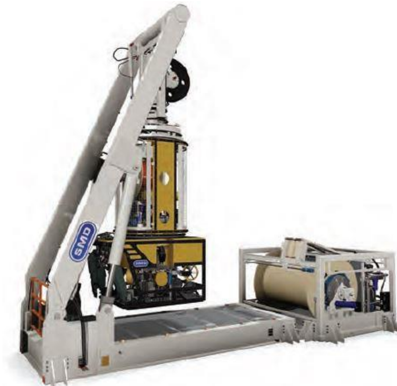
Figur 10 - ATOM ROV klar til montering på et skibsdæk. ROV'en bliver søsat ved, at man svinger den ud over siden på skibet, og derefter hejser den ned i vandet.
