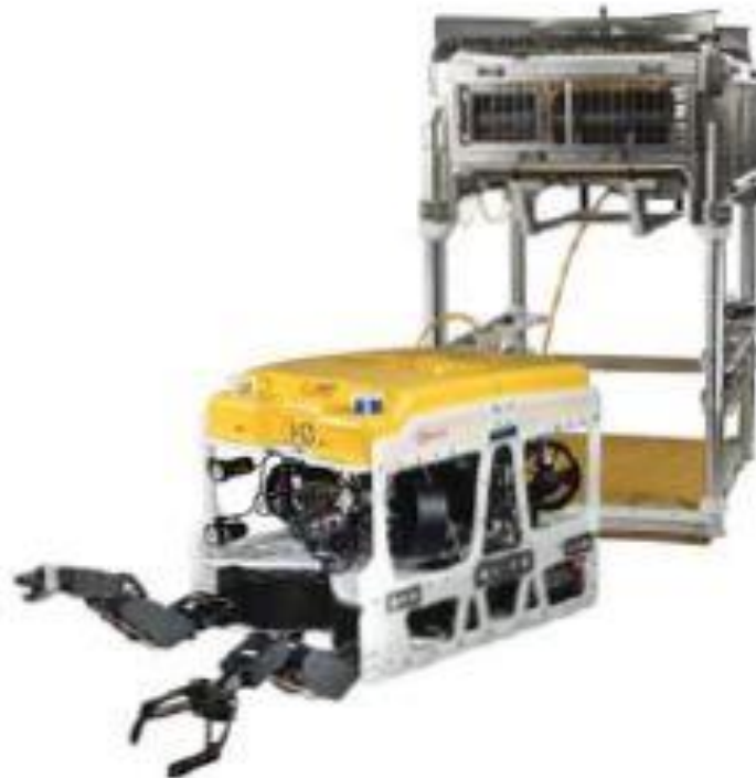
Figur 11 - ROV med TMS. TMS'en yder beskyttelse samt muligheden for at skifte værktøj hurtigt og nemt.
