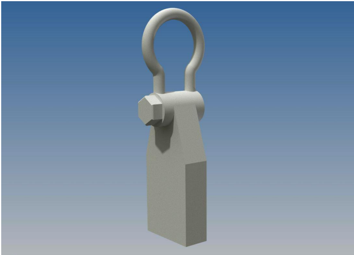
Figur 45 - Tegnet og generet o Inventor. Shaklen er udelukkende til at illustrere funktionen med, den endelige shakel vil få andre dimensioner.
