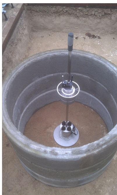
Figur 4.1. Faldlodsmåling på planum.
