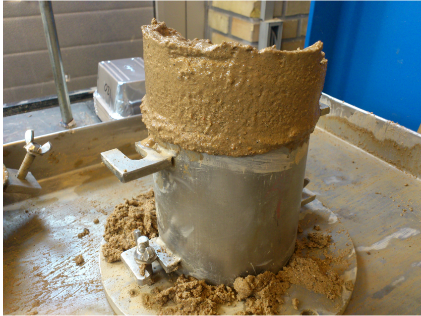
Figur 3.5. Våd prøve i proctor form inden prøvetagning.
