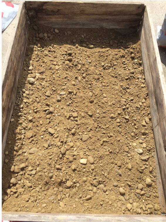
Figur 4.12. Stabilgrus med 40% runde korn.
