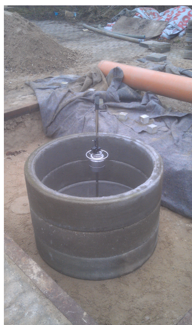
Figur 4.2. Faldlodsmåling på planum.
