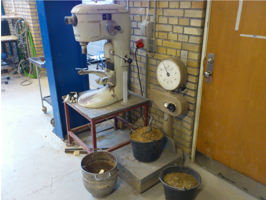
Figur 3.4. Mixer til omrøring af blandinger. På vægten ses bundsikringen og i spanden ved siden af ses en blanding af stabilgrus.
