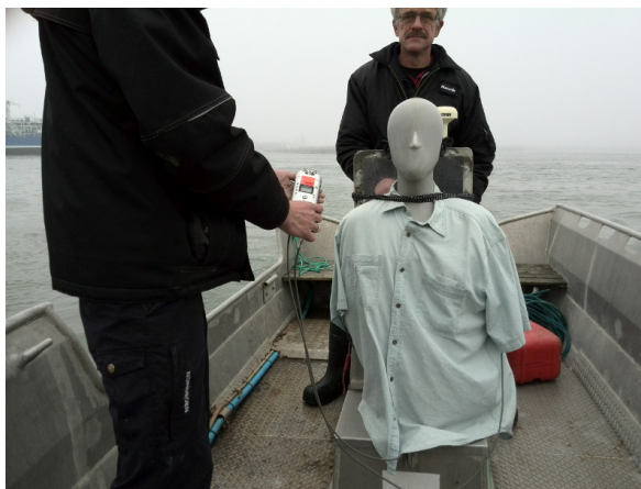
Figur 6.4. Setup ved optagelse af havlyd.
