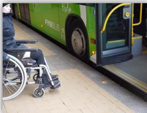
Figur 2-3 På en lavgulvsbus er der et trin som en kørestol ikke kan komme over.
