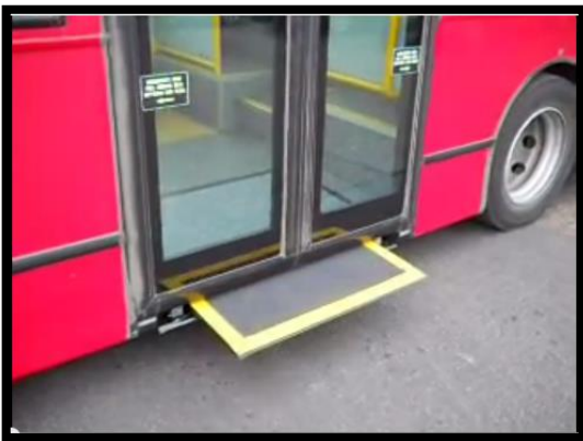
Figur 6-8 Elektronisk rampe på engelsk bus, den er sammenpasset med en forhøjet kantsten som chaufføren kører hen til når en person trykker på en knap i bussen (King, 2012)
