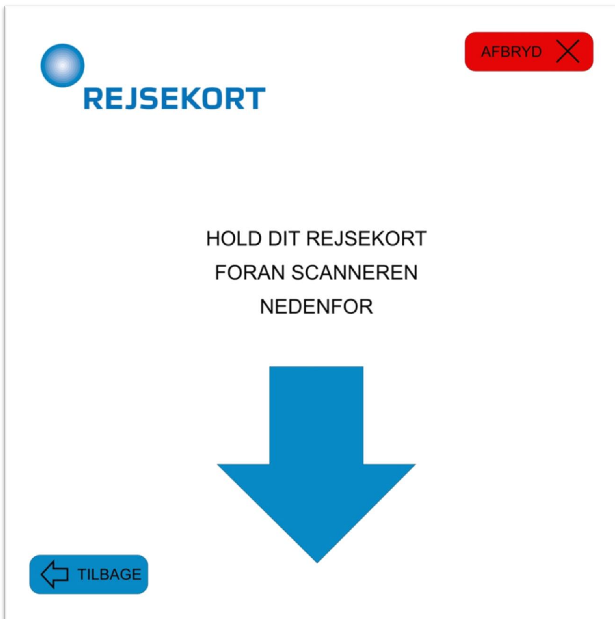
Figur 15: Viser et skærbillede det beder brugeren om at checke ind på den zonedefinerede rejse ved at holde kortet foran scanneren nedenfor skærmen. Brugeren kan også komme tilbage, til den foregående side, ved at trykke "Tilbage" eller afbryde processen og komme til hovedmenuen ved at trykke "Afbryd".
