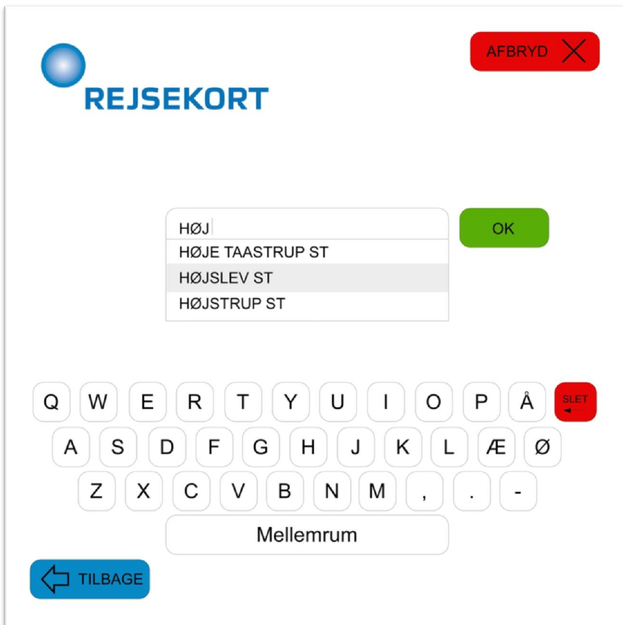
Figur 13: Viser hvordan automaten løbende kommer med forslag til mulige stationer fra databasen, på baggrund af hvad brugeren indtaster. Brugeren har dermed mulighed for både at skrive stationen helt ud og trykke "OK" eller vælge den ønskede station fra den genererede liste. Brugeren kan også komme tilbage til hovedmenuen, ved enten at trykke "Tilbage" eller "Afbryd".
