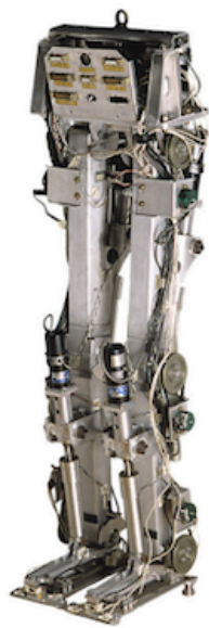
Figur 23: Billede af Asimos udvikling fra 1986 til i dag. Her ses det, hvordan fokuset er ændret fra kun at være ben og udviklingen af dens gangegenskaber, til at være hele robotens krop der er fokus på. Robotten er blevet mere menneskelig i dag, end i 1986.
