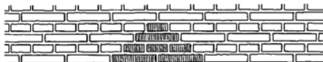
Krydsforbandt: Kop - Løber - 3 kopper - 2 løbere. (De placeres midt over hinanden)
