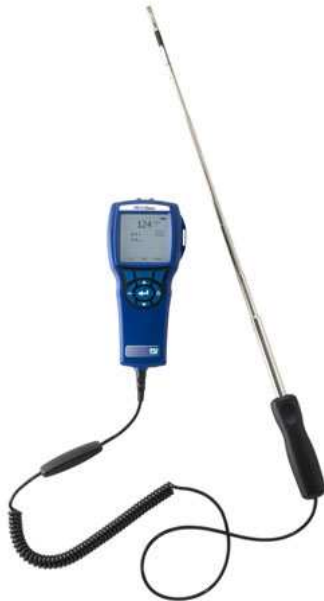
Figur 7: Q-Trak måler. Måler lufthastighet, temperatur og fuktighet.
