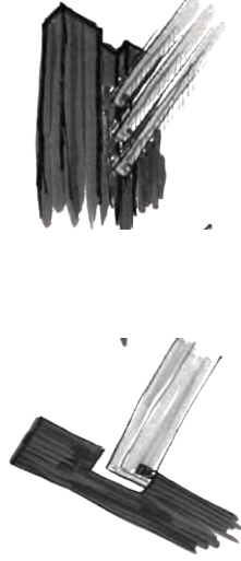
69.6-7 Samling mellem let og tung konstruktion i toppen af bygningen.
