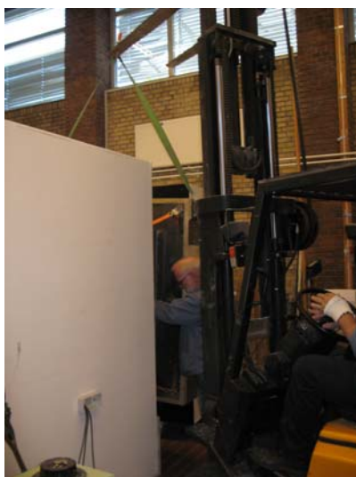
Figur 16.14: Figuren viser et billede af testelementet der løftes på plads i hot box'en.
