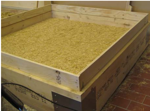
Figur 16.12: Figuren viser styrrammen benyttet ved komprimering af testelementerne.
