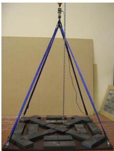
Figur 16.10: Figuren viser et billede af det benyttede hejsesystem der er lavet til komprimering af halmen, påført en last i form af x antal 10 kg jernlodder.
