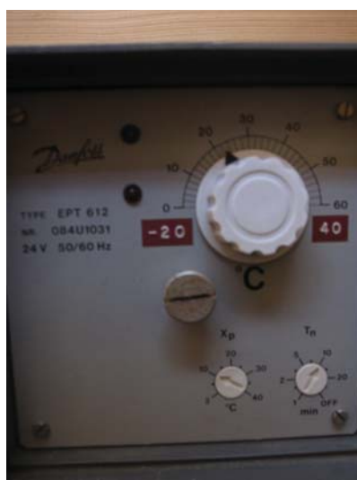
Figur D.3: Figuren viser et billede af indstillingerne på Danfoss EPT 612 til styring af den kolde side.
