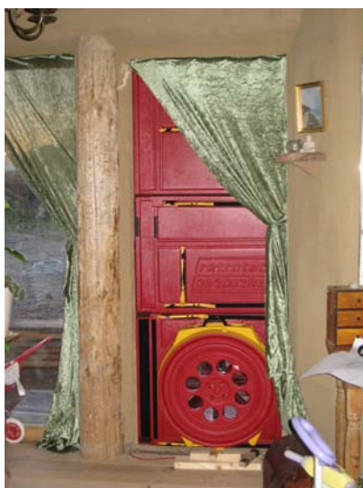
Figur 21.4: Figuren viser den opsatte blowerdoor i den vestlige facade.
