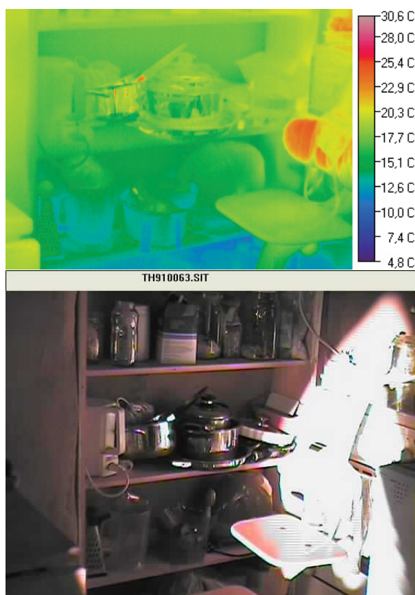
Figur 21.18: Figuren viser kuldebro ved reolen på den nordlige væg. Billedet er taget før forsøget. Billed 10.
