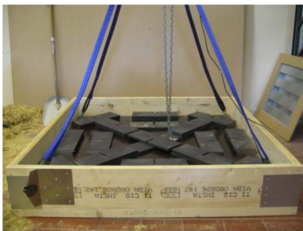
Figur 16.11: Figuren viser udførelsen af en komprimering med 300 kg.
