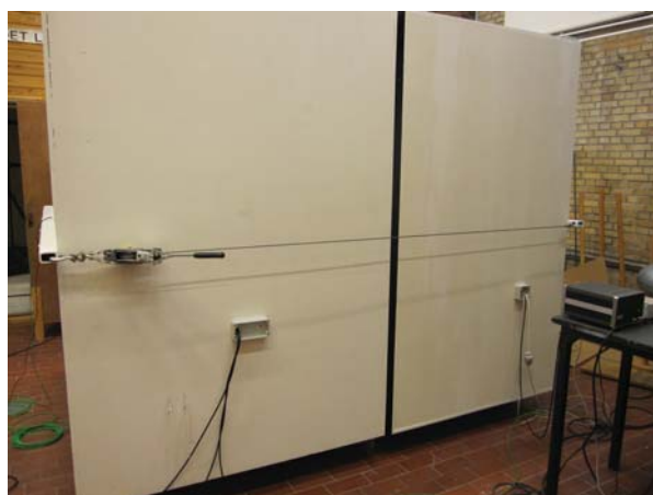
Figur D.2: Figuren viser et billede af hot box'en, trukket sammen med en wire.
