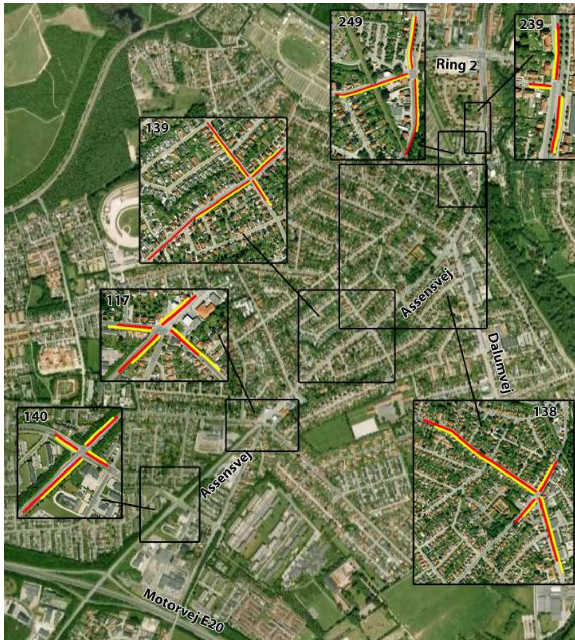
Figur 6.23: Illustration af de største beregnede kølængder for hvert kryds med og uden MOTION. Rød indikerer kølængden med MOTION og gul indikerer kølængden uden MOTION. (Ikke målfast)
