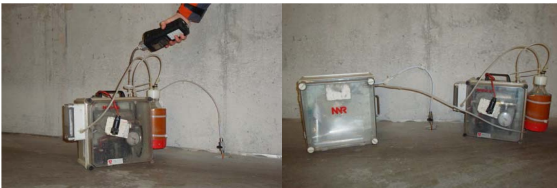
Figur 2. Udtagning af poreluftsprøve. Billedet til venstre er måling af direkte PID fra prøvetagningspumpens afkastluft. Det højre billede er udtagning af luftprøve i rilsanpose, se Figur 3 for tydeligere princip bag udtagningen.
