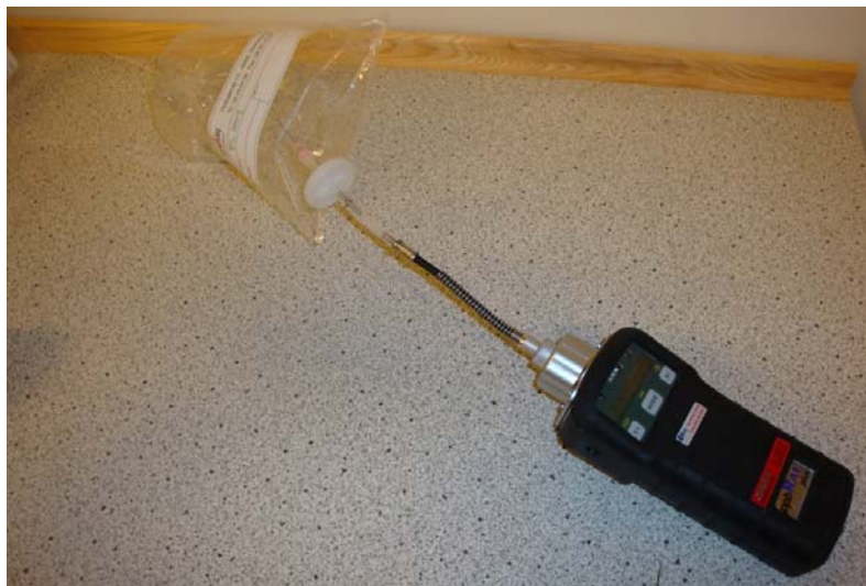
Figur 4. Måling af PID i rilsanpose med ppb-RAE.
