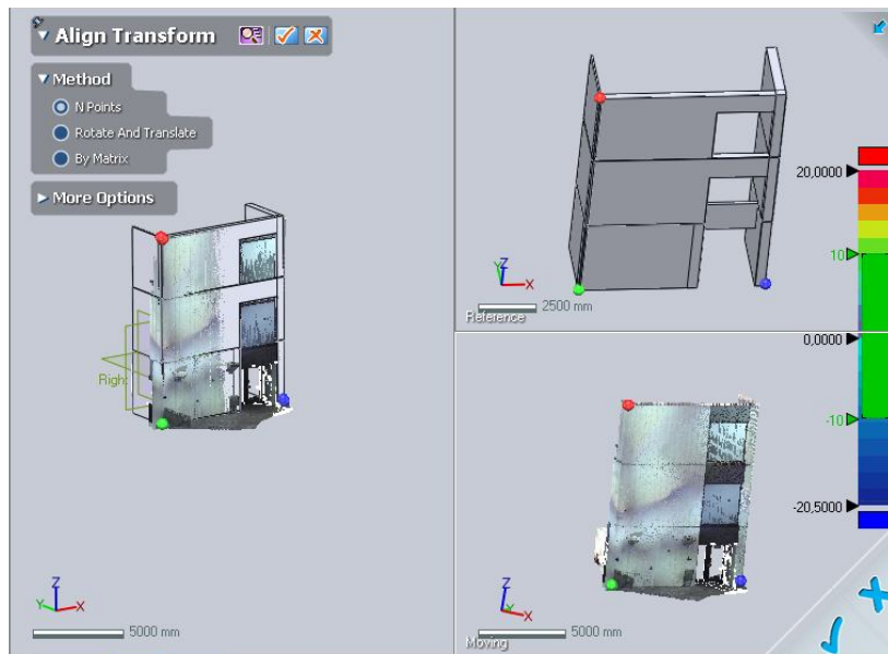
Figur E.4: 3D model og scanningsdata efter oriering i inspektionssoftwaren. Screenshot fra Rapidform XOV2.
