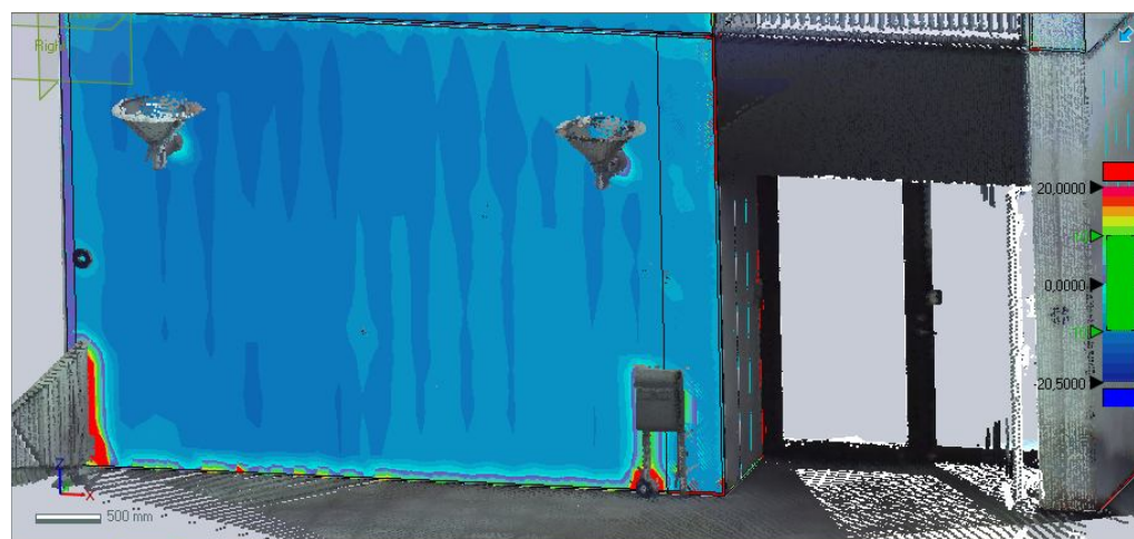
Figur 9.8: Visualisering af afvigelser og scaningsdata i Rapidform XOV2. Som det ses giver lamperne ikke anledning til afvigelser pga. valget af maksimalt tilladelige afvigelse på 100 mm.
