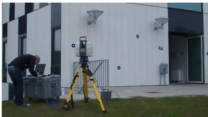
Figur D.2: Placering af targets på gavlen af bygningen.
