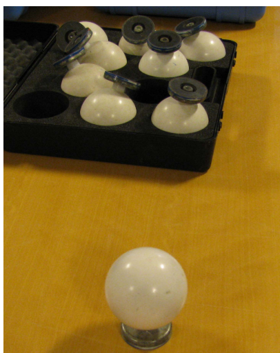
Figur 8.4: Eksempel på kugletarget. Billede fra besøg hos Rambøll Esbjerg
