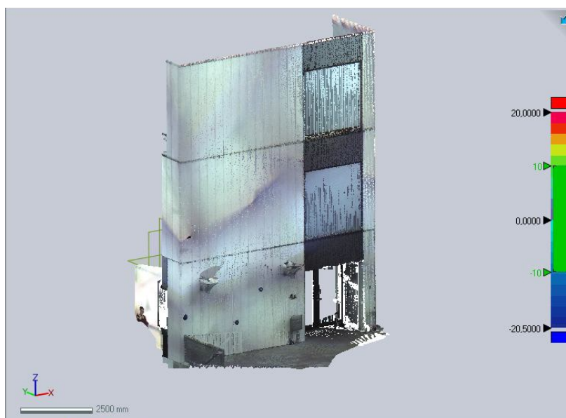
Figur E.2: Scanningsdata efter import til inspektionssoftwaren. Screenshot fra Rapidform XOV2.
