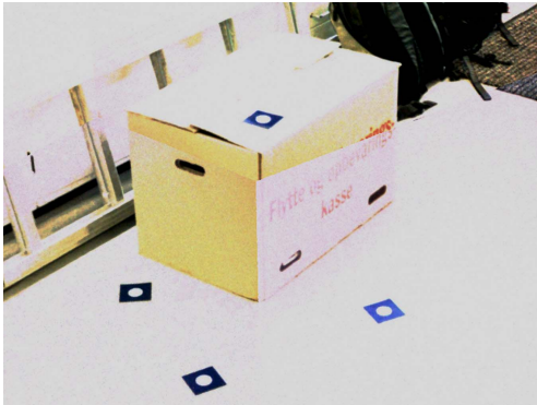
(a) Flyttekasse med targets, billedet er fra scannerens digitalkamera.
