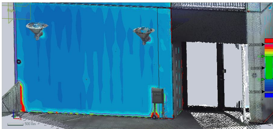
Figur E.8: Visualisering af afvigelser og scaningsdata. Som det ses giver lamperne ikke anledning til afvigelser pga. valget af maksimalt tilladelige afvigelse. Screenshot fra Rapidform XO2.
