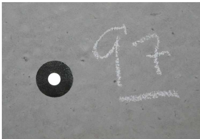
Figur 11: Fotogrammetrisk target til automatisk genkendelse
