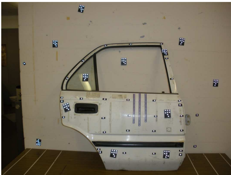
Figur 10: Eksempel på terrestrisk fotogrammetri, hvor kodetargets er anvendt på en bildør.
