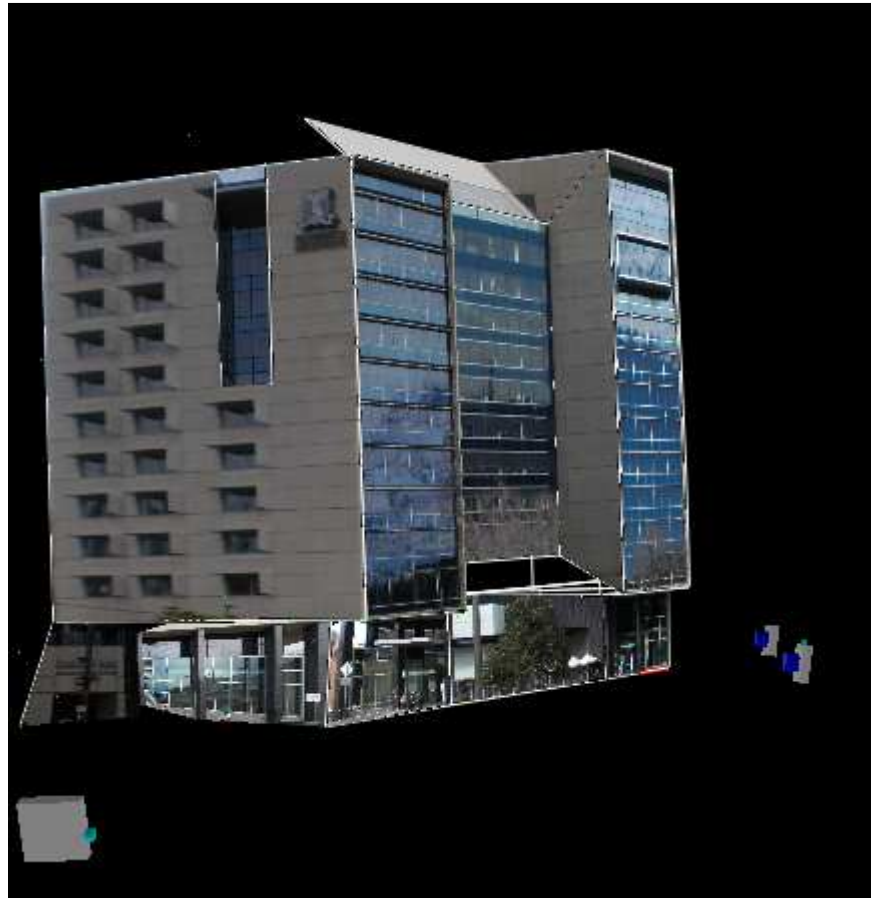
Figur 9: Bygning opmålt ved hjælp af fotogrammetri i programmet iWitness
