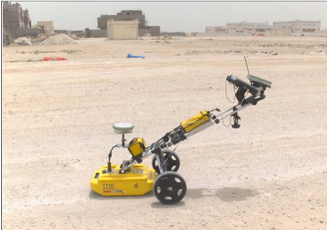
Figur 17.1 - Billedet viser GPS antennen monteret over antennen.
