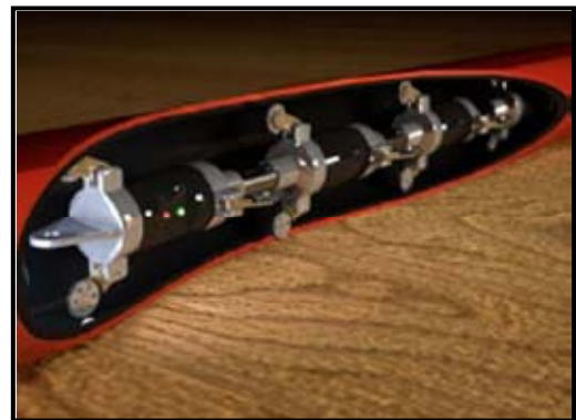
Figur 5.7 - Billedet viser en leddelt PipeTrack sonde. [Infotec]
