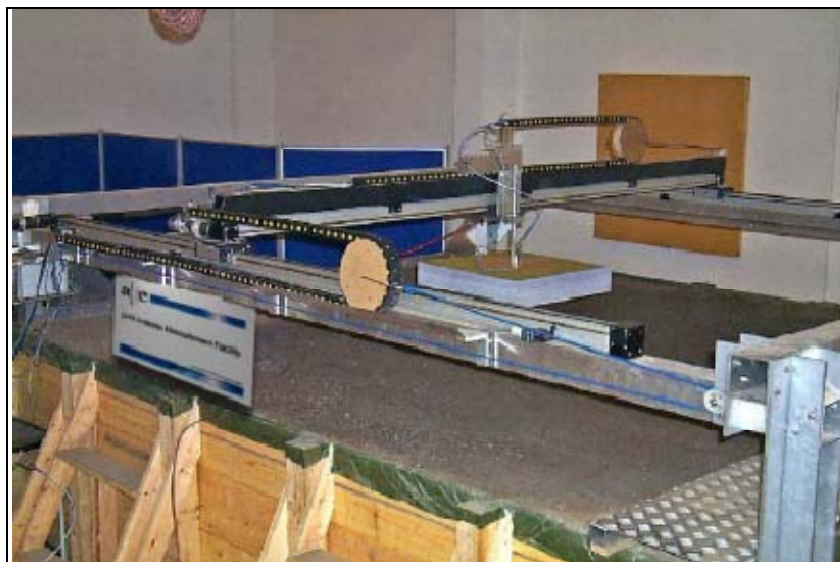
Figur 9.1 - Billedet viser testanlægget og især kranbanen, der bevæger antennen. [Lenler-Eriksen]
