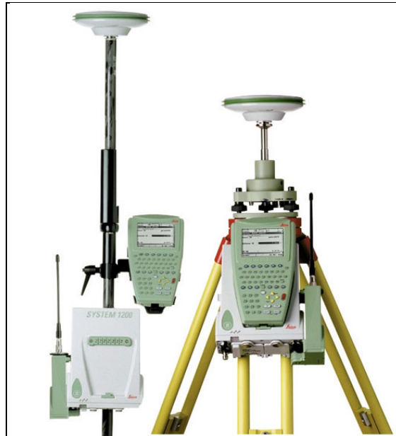
Figur 12.3 - Billedet viser rover og base til Leica GPS 1200+. [www.geosoft.ch]
