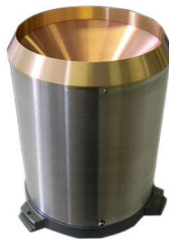
Figur 2.5 Tv. Rimco regnmåler. (McVan Instruments u.d.) Th. Skitse af Eksempel på vippekarsregnmåler
