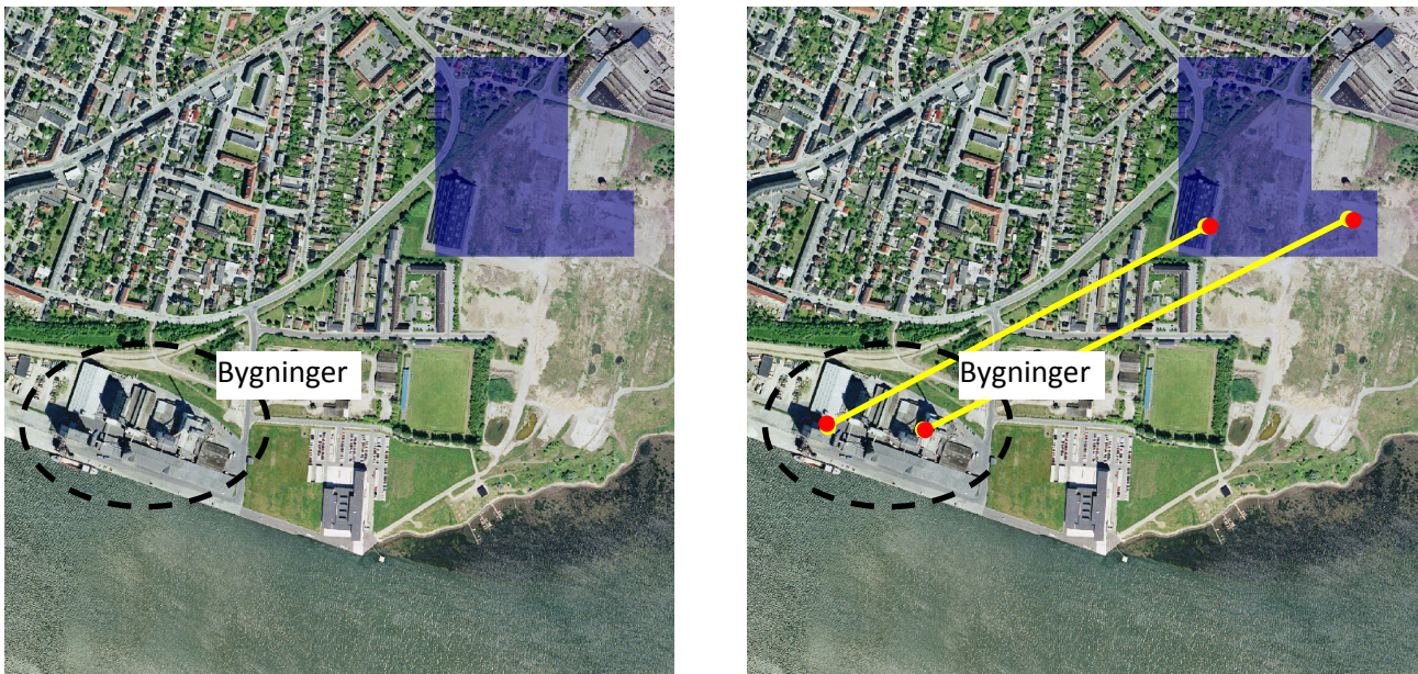
Figur 3.5 Billede til venstre viser området med de høje Hedegaards bygninger, og det generede clutter. Billede til højre viser de anvendte referencepunkter til bestemmelse af timing og orientering. De gule streger er radiale på radaren.
