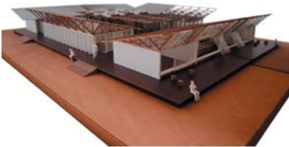
III.112 Model af centret. Det hævede tag giver både bygningens karakter, danner passiv køling og trækker dagslys ind i rummene.
