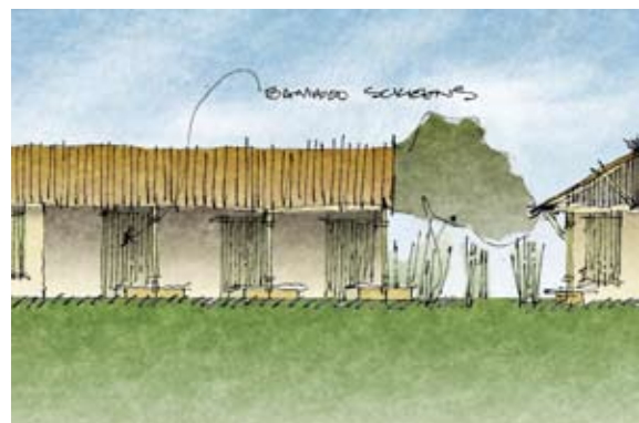
III.117 Klinikken bygges af bambus og mursten af sammenpresset jord.
