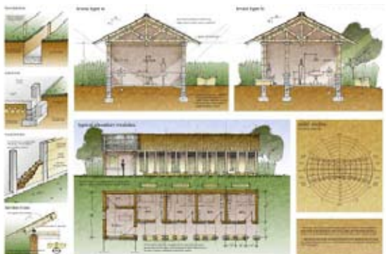
III.118 Bygningernes saddeltag er udformet, så direkte lys kan trænge ind i rummene.
