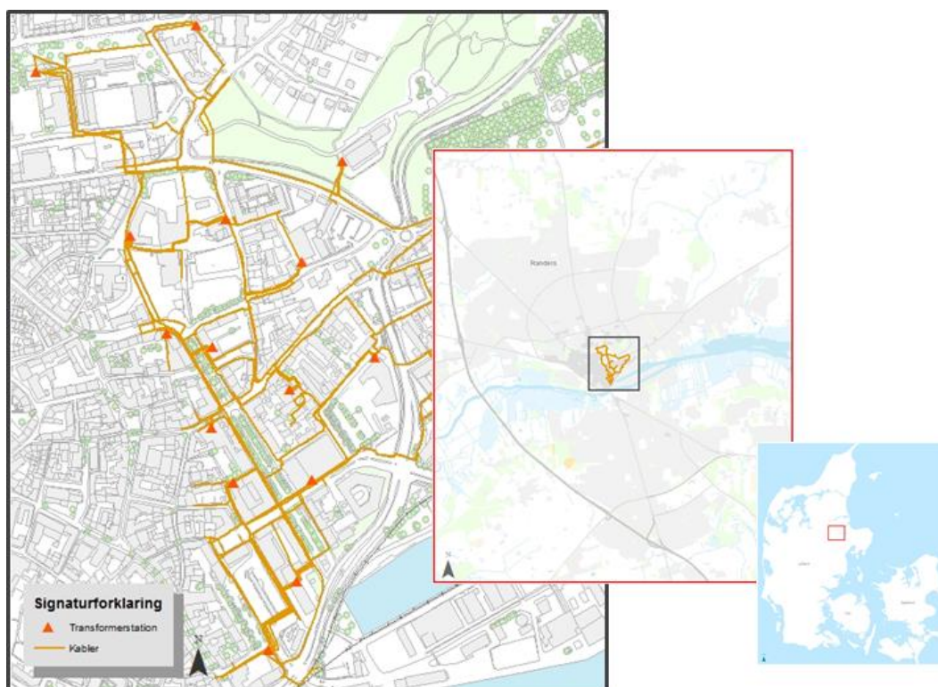
Figur 4.1, Oversigt over den del af elnettet, der er en del af VERA testområdet. Desuden et oversigtskort over testområdets lokalisering i Randers by og Randers geografiske placering på Danmarks kortet. Når dokumentet er layoutet og klar til print, skal grupperingen fra denne figur og figurtekst fjernes, således at det midterste billede kommer til at ligge ovenpå ledningskortet, men under danmarkskortet.
