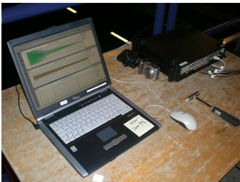
Figur 16 Dataopsamler, hammer og pc med PULSE.
