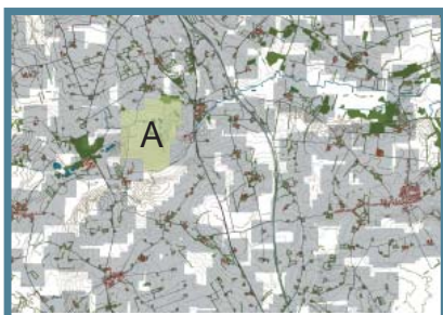
Fig.174 Område A ligger i et område hvor der kan opstilles vindmøller samtidigt med, at sikkerhedsafstanden på 600 m til nærmeste bebyggelse overholdes.
