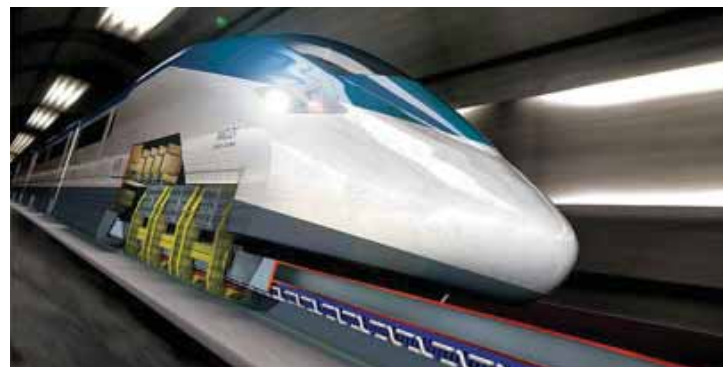
Fig. 15 Illustrationen viser højhastighedstoget fra Shanghai. Toget har en top hastighed på 430 km/t.
