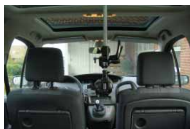
Fig.77 Videokameraets placering i bilen
