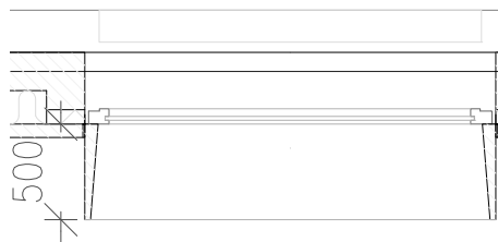
Figur F.18: Tegning af det konstruktive udhæng på 0,5m, der er udført omkring hele vinduet.
