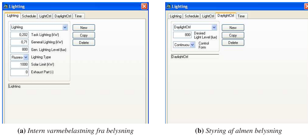
Figur G.15: Opsætning af system for intern belastning fra belysning
