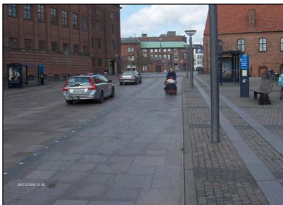
Figur 11.15 Eksempel fra Klosterbakken i Odense hvor en kørestolsbruger har valgt den jævne belægning.
