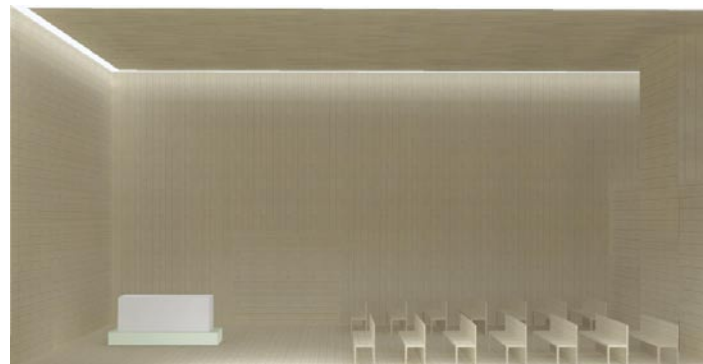
LYSSIMULERING AF KOMBINATION MED STORT VINDUSPARTI OG LOFTSPRÆKKE I KAPELSALEN.
